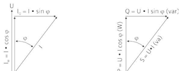
Con el fin de mejorar el factor de potencia, se compensa la potencia reactiva de magnetización, utilizando para ello condensadores de potencia. De esta manera, se descargan los generadores, las líneas de transmisión y los transformadores de distribución de la potencia reactiva, con lo cual se colabora a mantener la tensión en la red, y se eleva la potencia activa a transportar. Se distinguen las siguientes clases de compensación.
